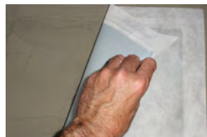
Pegar la lámina al otro lado del pre-corte.
